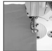
Den Schlauch wenden und über der ausgebügelten Naht fübchenbreit steppen.
