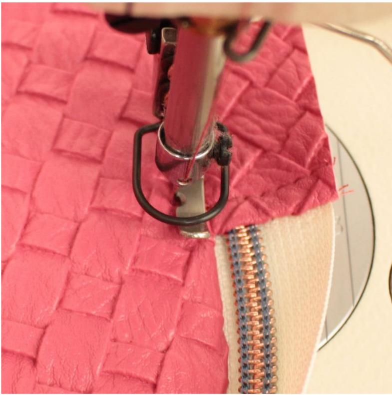
Vom Reißverschluss aus ca. 5 mm in den Deckel hinein nähen. Die Nadel unten lassen, Füßchen heben und das Teil in Nahrichtung drehen, Füßchen senken und weiter parallel zum Reißverschluss steppen.
