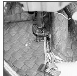
und parallel zum Reißverschluss weiter nähen. Die Naht endet wieder auf der Verlängerung vom Reißverschluss.
