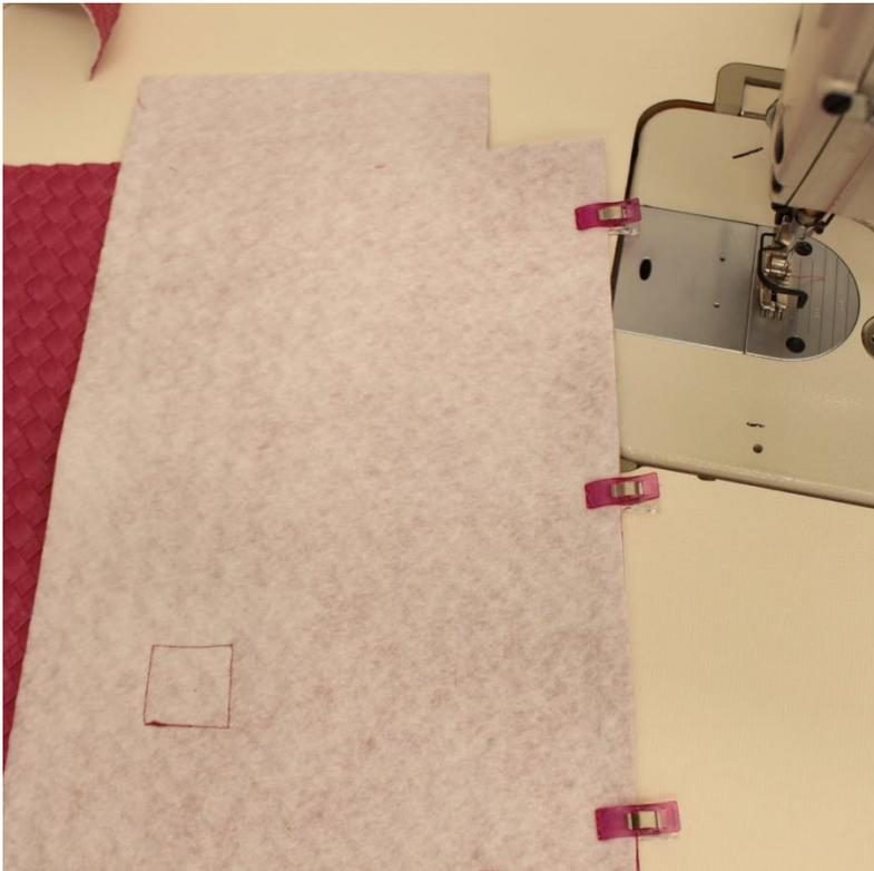
Mit Klammern die beiden Teile fixieren und mit 1 cm Nahtzugabe nähen.
